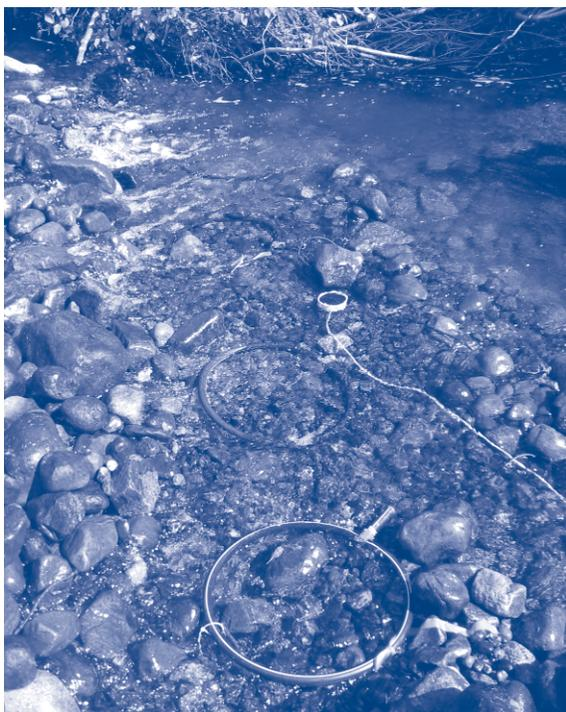
Réseau d'antennes permettant le suivi en continu et en temps réel des mouvements des poissons marqués avec des PIT-tags (Geosalar II) (Photo: Patricia Johnston).
